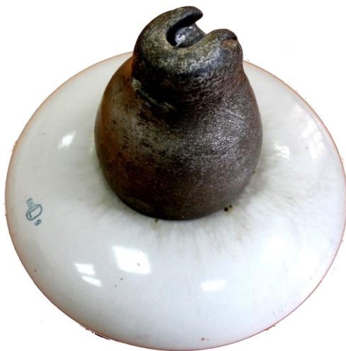
Рис. 1. Поверхность фарфорового изолятора со следами эрозии
