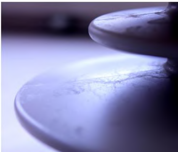
Рис. 2. Следы эрозии, распространяющиеся от шейки изолятора к его периферии
