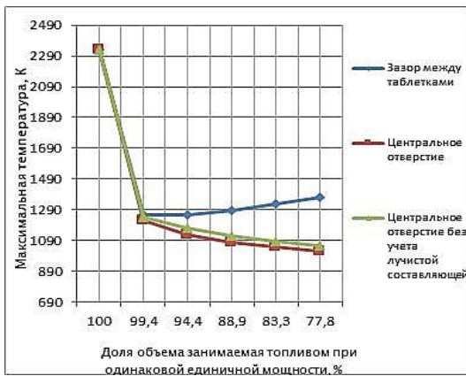
Рис. 1. Зависимость максимальной температуры топлива от доли объема ТВЭЛа, занимаемой топливом, при одинаковой единичной мощности
