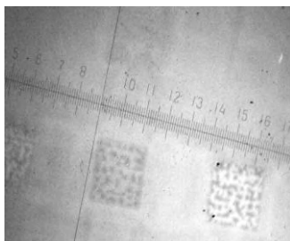
Рис. 5. Структурные изменения в тонкой пленке МЖ в переменном электрическом поле в матричной системе электродов
