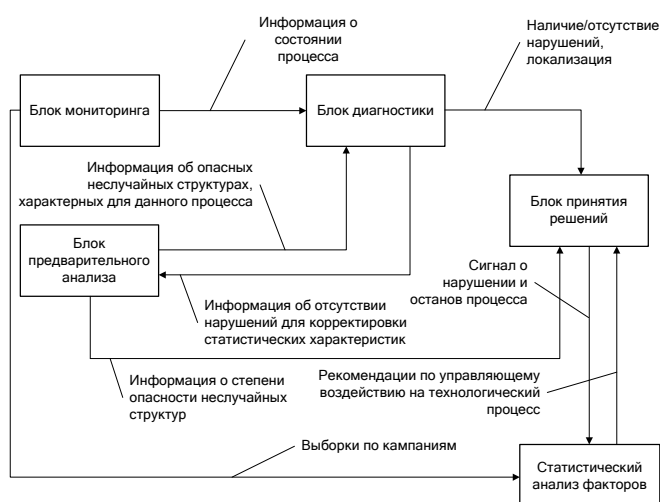
Рис. 1. Модульное представление автоматизации проактивной СМК
