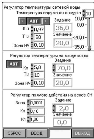
Рис. 2. Видеокادر «Регуляторы котельной»
