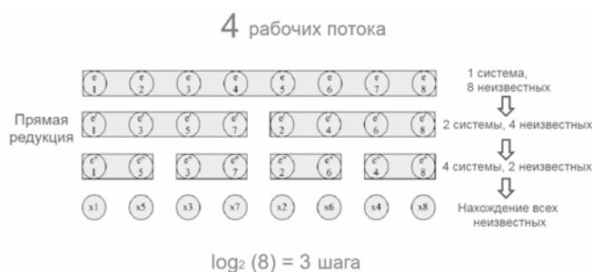
Рис. 1. Параллельная циклическая редукция
