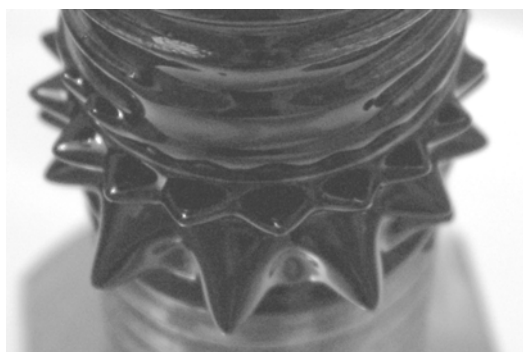
Рис. 1. Поверхность болта с магнитной жидкостью
