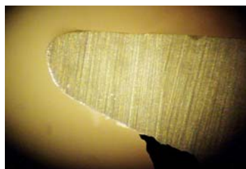
Рис. 1. Фотография резца до нарезания зубьев профильной ленты
