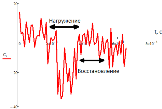
Рис. 1. Восстановленный ударный импульс (несмазанный подшипник)
