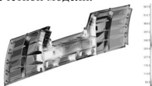
Рис. 1. Диаграмма напряжений нижней окантовки двери багажно-грузового отсека
