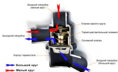
Рис. 1. Конструкция и принцип действия термостата
