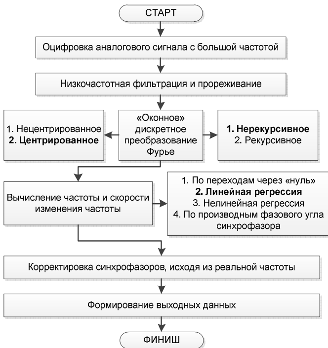
Рис. 1. Блок-схема цифровой обработки сигналов с целью реализации СВИ
