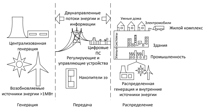
Рис. 1. Схема сети с распределенной генерацией
