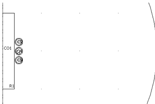
Рис. 1. Геометрия модели индукционного нагрева
