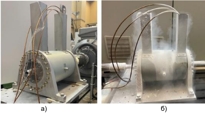
Рис.1. Фото асинхронного двигателя на испытательном стенде на воздухе (а) и в жидком азоте (б)
