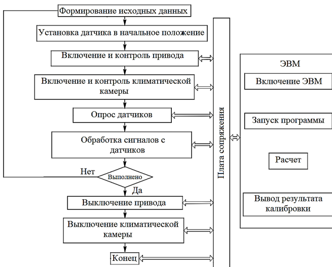
Рис. 2. Алгоритм калибровки гироскопа ВТГ
