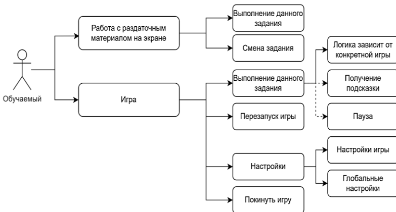
Рис. 1. Функциональная схема работы с приложением с точки зрения обучаемого
