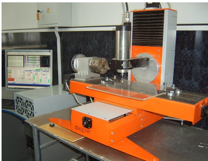
Рис. 1. Фрезерно-гравировальный станок Cutter FG 380x190x140
