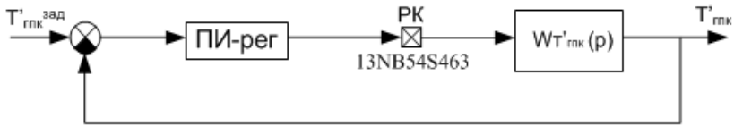
Рис. 2. Структурная схема регулятора температуры конденсата на входе в ГПК: W_{T'_{гпк}}(p) – передаточная функция объекта по каналу «положение регулирующего клапана – температура на входе в ГПК»; T'_{гпк}^{зад} – сигнал по заданной температуре на входе в ГПК; T'_{гпк} – сигнал по температуре на входе в ГПК; РК – регулирующий клапан; ГПК – газовый подогреватель конденсата
