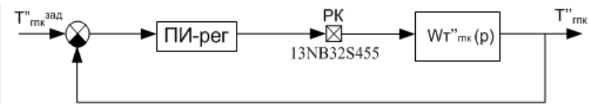
Рис. 3. Структурная схема регулятора температуры конденсата за ГПК: W_{T''_{гпк}}(p) – передаточная функция объекта по каналу «положение регулирующего клапана – температура на выходе из ГПК»; T''_{гпк}^{зад} – сигнал по заданной температуре на выходе из ГПК; T''_{гпк} – сигнал по температуре на выходе из ГПК; РК – регулирующий клапан; ГПК – газовый подогреватель конденсата
