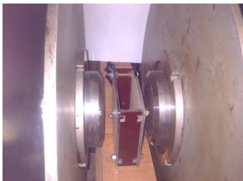
Рис.6. Ячейка между наконечниками установки ФЛ-1
