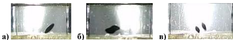
Рис. 3. Форма МЖ а) H_\infty = 75 Э, f = 3 Гц; б) H_\infty = 100 Э, f = 5 Гц; в) H_\infty = 125 Э, f = 4 Гц
