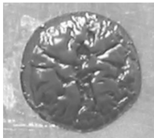
Рис. 4. Фотография капли (вид сверху) четырехкратно разбавленной жидкости № 1 на поверхности нагревателя при температуре 110°C в переменном магнитном поле 4...5 кА/м.
