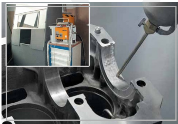
Восстановление посадочных мест под подшипник напылением
