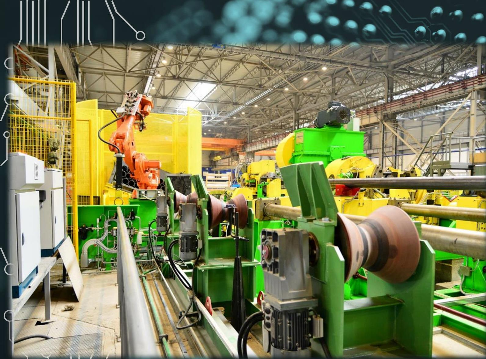
*Установка навертки муфт на трубы с роботизированной подачей заготовки.*
