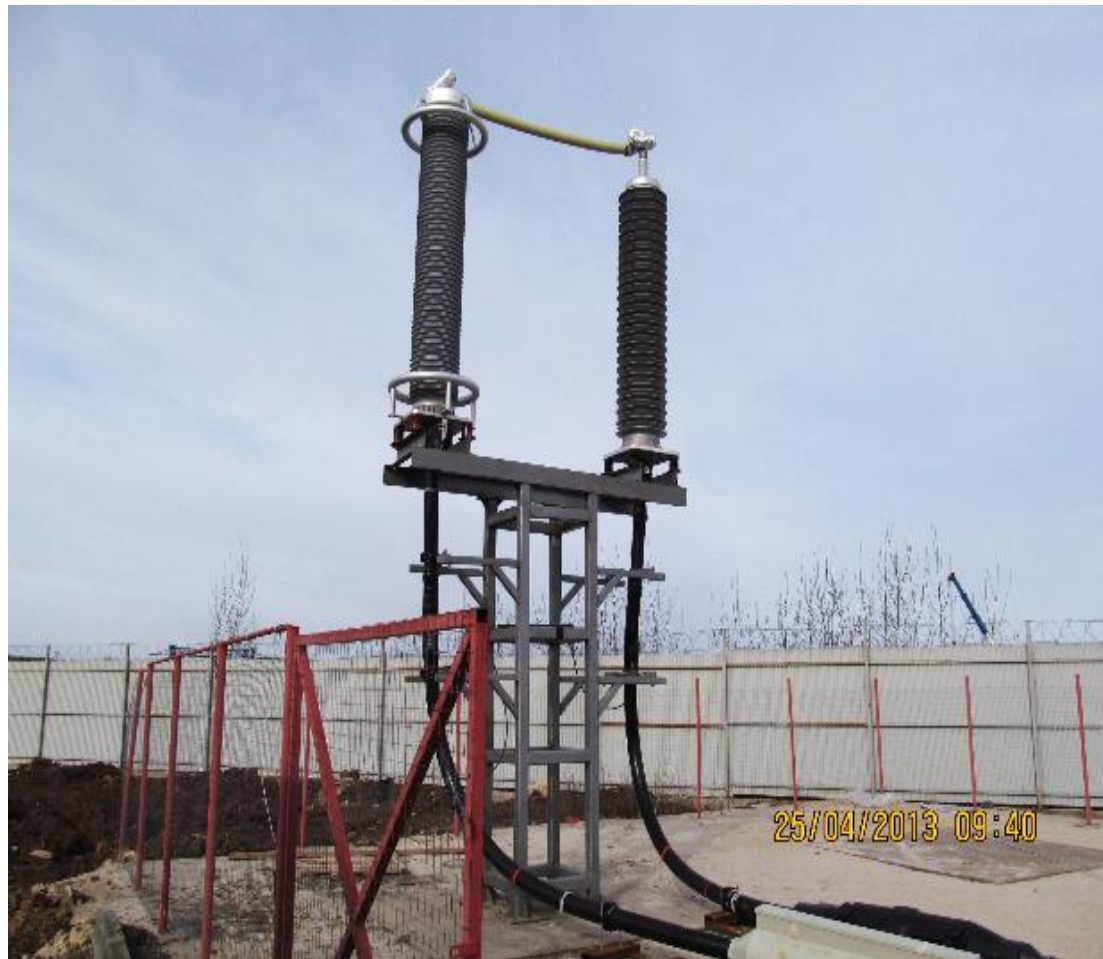
Испытательный стенд для имитации различных условий: внутри помещения, в трубах, в земле, на открытом воздухе.
