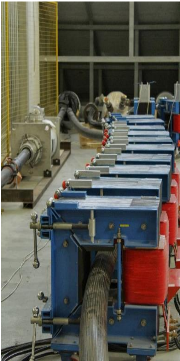
Испытательный стенд для имитации различных условий: внутри помещения, в трубах, в земле, на открытом воздухе.
