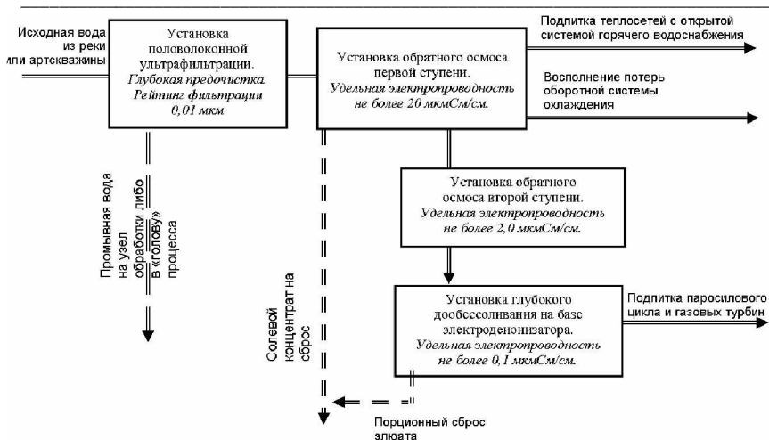
Рис. № 1. «Принципиальная схема потоков обессоливающей установки с использованием электродеионизатора»
