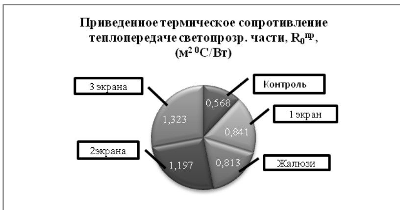
Рис. 1. Приведенное термическое сопротивление теплопередаче
