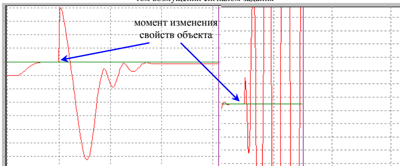
Рис.4. Переходные процессы в системе с нечетким (слева) и обычным ПИ-регулятором при параметрическом возмущении (резкое изменение коэффициента усиления объекта)
