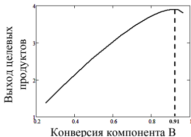
Рис. 2. Зависимость выхода целевых продуктов от конверсии компонента В при (G_3/G_4)^3 = 1.0 при различных G_A^0 , кг/ч
