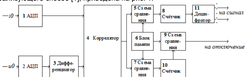
Рис. 1. Функционально-логическая схема направленного устройства сигнализации ОЗЗ по способу [1]
