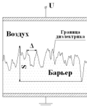
Рис. 1. Характеристики поверхности барьера: S – шероховатость, \Delta – зернистость
