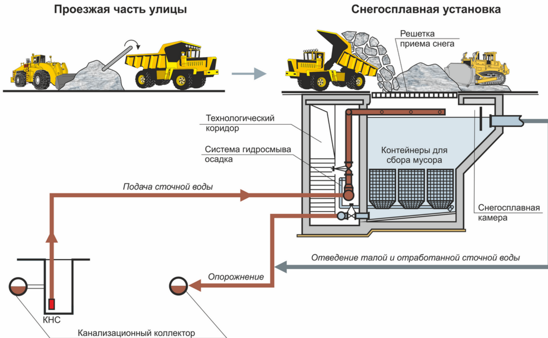
Рисунок 4.4 - Стационарная снегоплавильная установка на канализационном коллекторе
