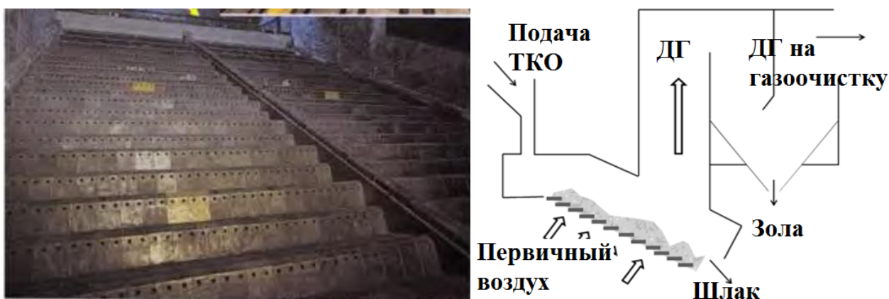
Рисунок 6.2 - Внешний вид (слева), схема работы наклонно-переталкивающей колосниковой решетки
