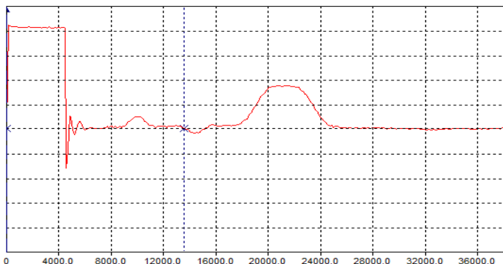
Рис. 2. Отражение зондирующего импульса от места обрыва ЛЭП
