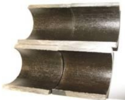
Рис. 2 - Состояние внутренних поверхностей образцов после обработки Cetamine V-211.
