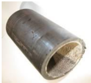
Рис. 3 - Состояние внутренних поверхностей образцов после обработки Cetamine V-2000
