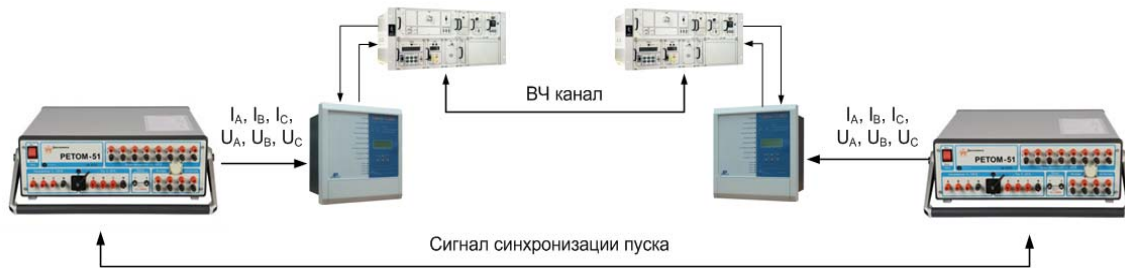
Рисунок 17 – Структурная схема стенда для проверки работы ДФЗ с использованием ВЧ приемопередатчиков ПВЗУ-Е
