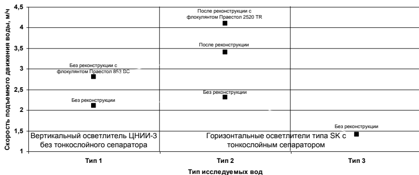
Рис. 7 Влияние типа воды, режимных и конструктивных факторов на максимальную допустимую скорость подъёмного движения воды в горизонтальных и вертикальных осветителях.
