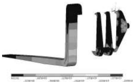
Рис.4. Распределение эквивалентных напряжений в области контакта (Па)
