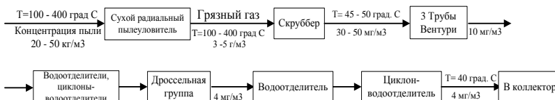
Рис. 1. Принципиальная схема газоочистки
