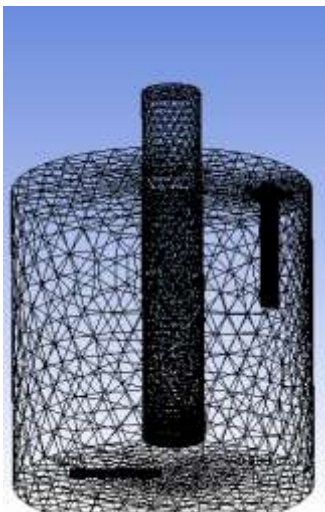
Рис. 2. Расчетная сетка пневмонасosa
