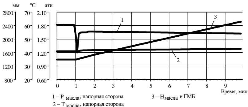
Рис. 5. Параметры масла, поступающего на смазку турбоагрегата – напорная сторона (при имитации разрыва)
