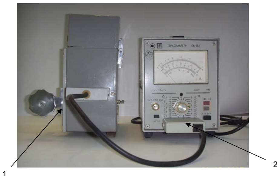
Рис. 2. Фотография прибора типа ИЭСТВ–1М: 1 – экранирующая камера с датчиком; 2 – измерительный прибор тераомметр
