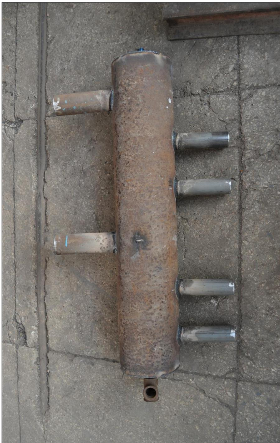
Рисунок 4.10 – Фотография термогидравлического распределителя для абонента «гараж»
